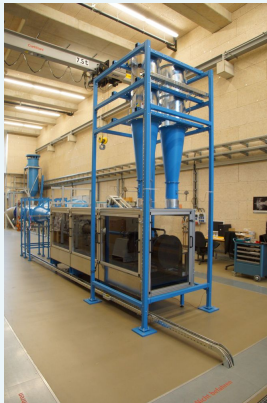
Prüfstands Aufbau für Umströmungs-untersuchungen einer Gasturbine in einem Package
