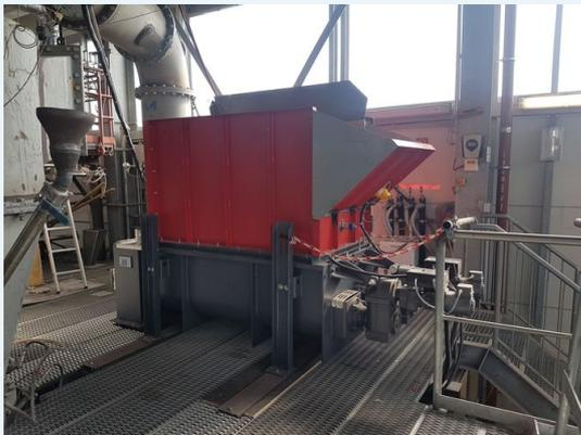
Über diesen Bunker wird der Ersatzbrennstoff in die Versuchsanlage eingebracht.
