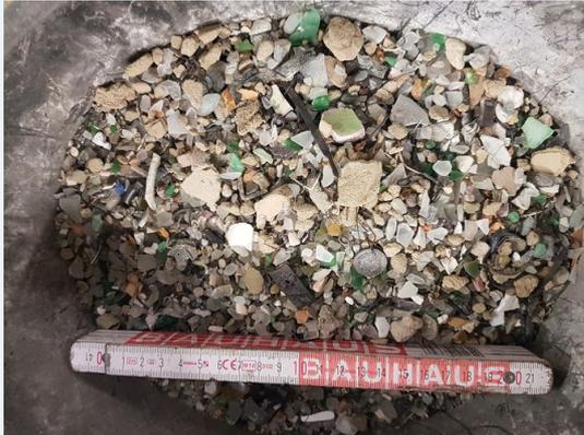
Aus der Wirbelschichtanlage werden unten die nicht brennbaren Bestandteile (Asche) abgezogen.
