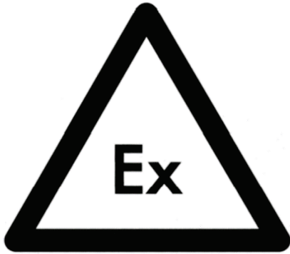
Abb. 4.6 Warnzeichen zur Kennzeichnung von Bereichen, in denen explosionsfähige Atmosphären auftreten können, gemäß Art. 7, Abs. 3, Richtlinie 1999/92/EG
