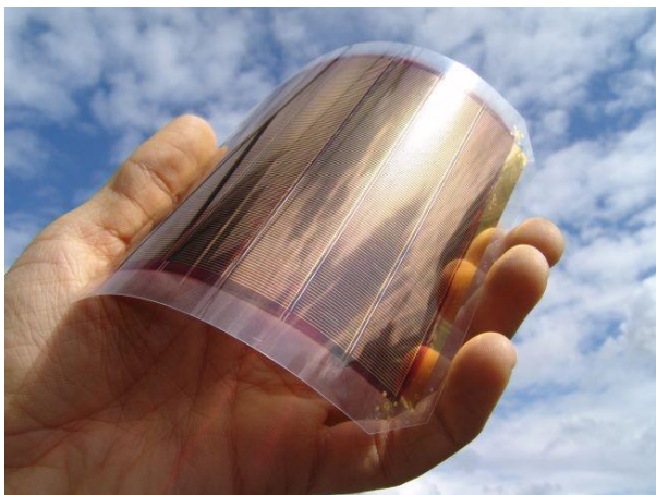
Organische Solarzellen ohne IndiumZinnOxid (ITO) auf einer flexiblen Folie.
