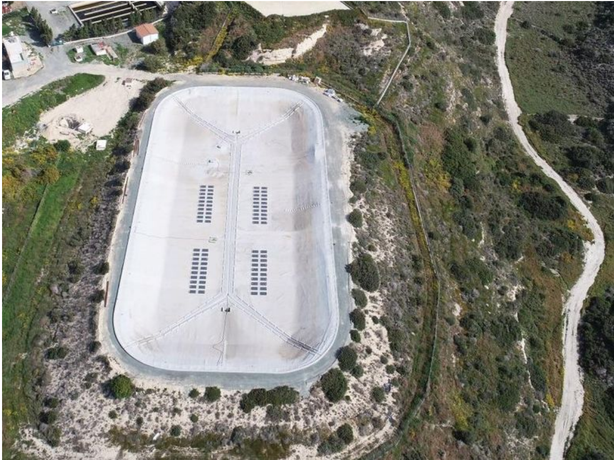
Das Foto zeigt eine Abdeckfolie für ein Wasserreservoir mit kristallinen Photovoltaik-Modulen in Zypern.
