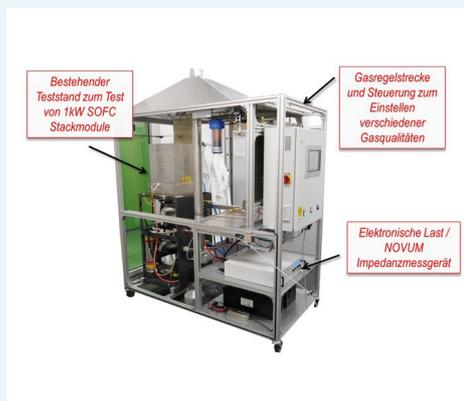
SOFC-Modulprüfstand mit Gasregelstrecke am Lehrstuhl für Energieverfahrenstechnik (FAU-EVT)
