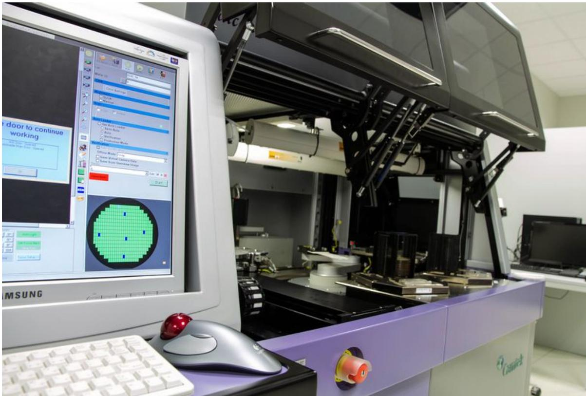
Ein Wafer für die konzentrierende Photovoltaik bei einer automatisierten optischen Kontrolle (AOI)
