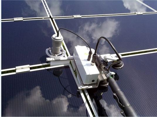
Berührungslose Spannungsmessung im Einsatz auf der Freilandanlage
