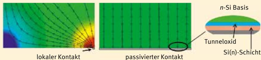
Abb. 1 Die Simulation verdeutlicht den Unterschied des Stromtransports in Solarzellen mit lokaler Rückseiten-Kontaktierung (links) und in Zellen mit dem neuen ganzflächigen, passivierten TOPCon-Rückseitenkontakt (rechts).
