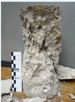
Das Foto zeigt einen Betonzylinder nach dem Ermüdungsversagen.
