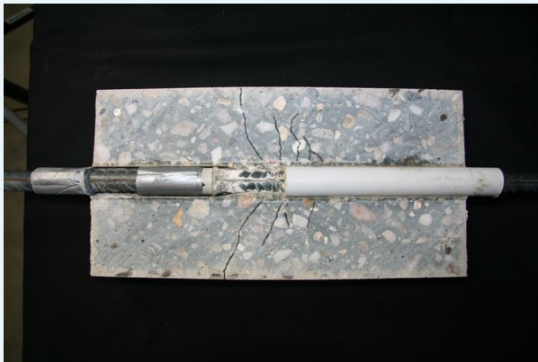
Das Foto zeigt einen Verbundbereich nach Auszugversagen mit Rissen (nachgezeichnet).
