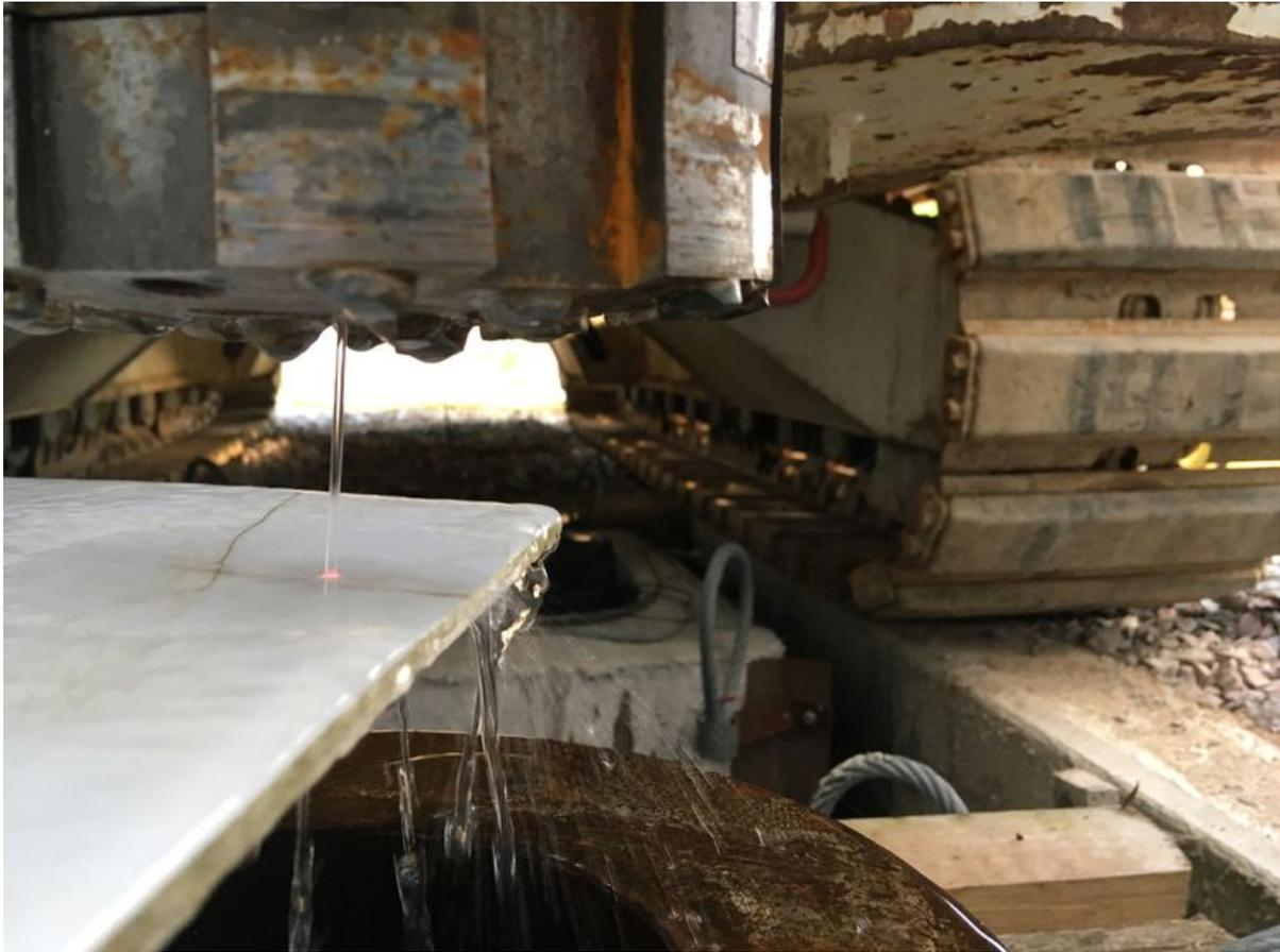
Der Bohrkopf mit integriertem Laserkopf befindet sich am Ende des Hybridbohrstrangs. Der austretende Laser-Wasserstrahl ist deutlich sichtbar.
