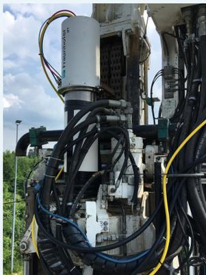
Der Faser-Faser-Drehkoppler befindet sich am Ende des Bohrstrangs direkt hinter dem Motor.
