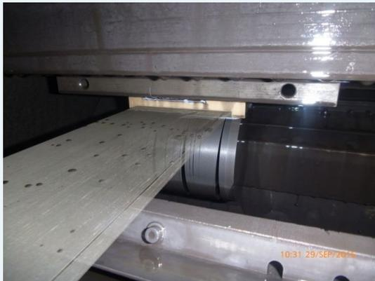
Das Foto zeigt einen gewaferten Siliziumblocks nach dem Sägen in der Drahtsäge mit einem angepassten Drahtfeld.
