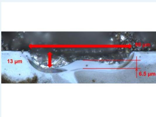
Die Lichtmikroskopaufnahme zeigt den Querschnitt eines durch Aluminiumpaste gebildeten lokalen Emitterbereichs. Die seitliche Diffusion von Silizium wird während der Schmelzphase reduziert. Dadurch bildet sich in der Rekristallisationsphase ein tieferer Emitterbereich.
